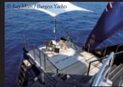
トランサムのプラットフォーム。完全に下ろした際には棧橋としても機能する
